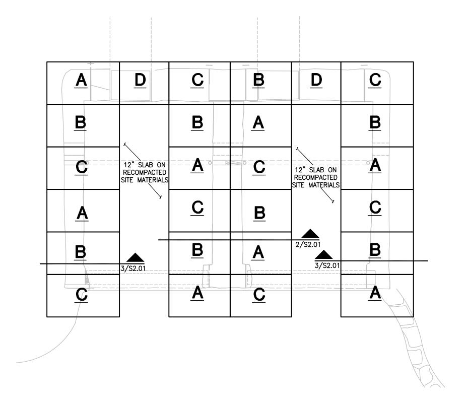
PUMP HOUSE FOUNDATION UNDERPINNING PLAN
